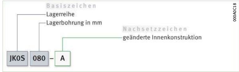
16 Integral-Kegelrollenlager: Aufbau des Kurzzeichens
